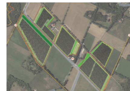
Figuur 32 Concept door Arcadis e TPSolar, Zonnepanelen (zwart), bosstrook (donkergroen), gras (lichtgroen).
